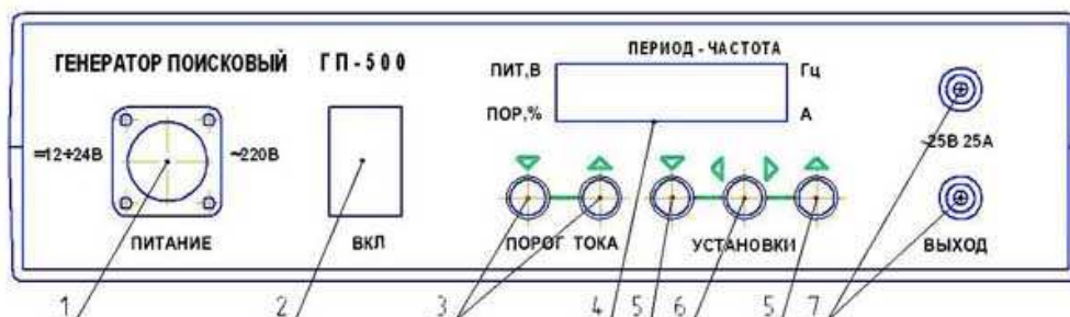
Рис.1. Лицевая панель генератора.
